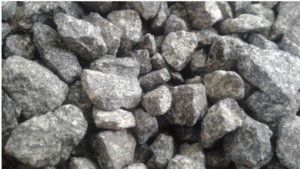
Figura 24. Detalle de los granos expuestos a cloro
