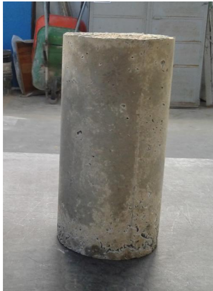
Figura 11. Cilindro de concreto a los 28 días, elaborado con 0,5 mg/L de cloro residual en su agua para la mezcla
