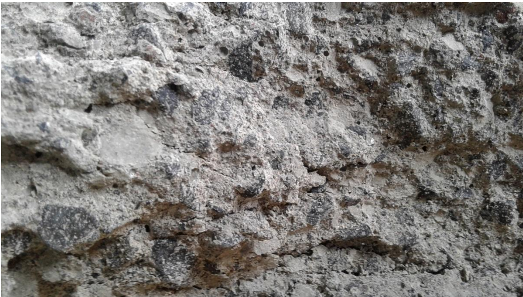
Figura 16. Presencia de cementante en polvo dentro del cilindro de concreto elaborado con 2,0 mg/L de cloro residual en el agua para la mezcla
