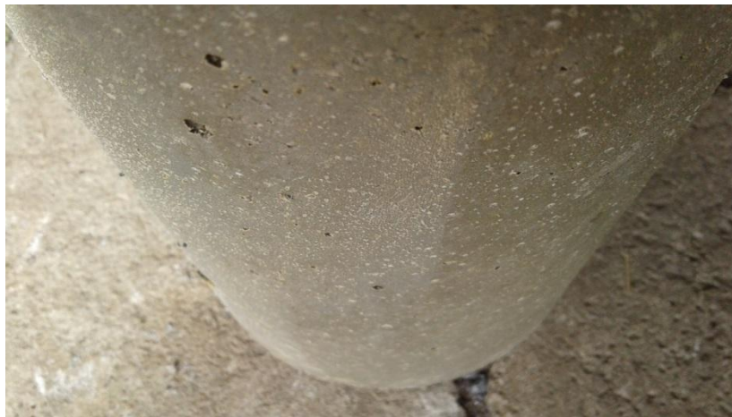
Figura 17. Cambio de coloración en cilindros elaborados con 2,0 mg/L de cloro residual en su agua para la mezcla
