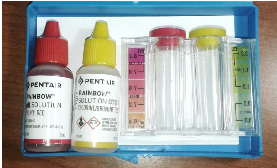
Figura 5. Comparador de cloro con goteros de reactivos
