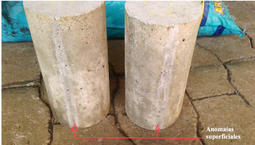
Figura 13. Anomalías superficiales en cilindros de concreto elaborados con 1,0 mg/L de cloro residual a los 14 días
