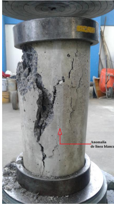
Figura 14. Ensayo a compresión de cilindro de concreto a los 14 días elaborado con 1,0 mg/L de cloro residual
