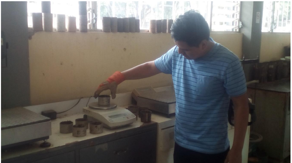
Figura 34. Pesaje de las muestras después de 24 horas en el horno
