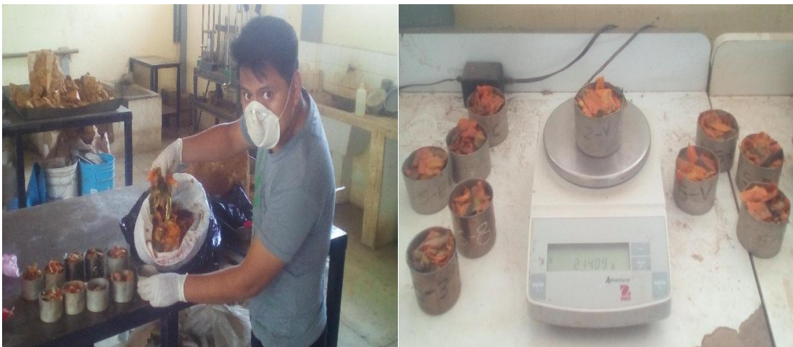
Figura 32. Preparación de las muestras para la prueba de humedad
