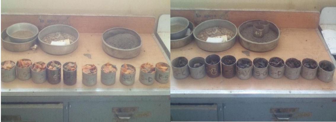
Figura 33. Muestras del antes y después de 24 horas en el horno
