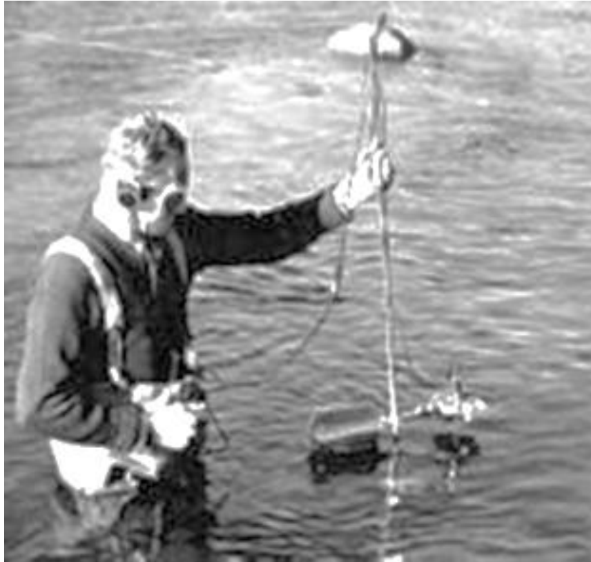
Figura 15. Medición con molinete
