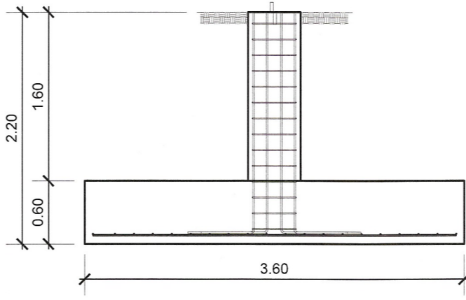
ELEVACIÓN ZAPATA TIPO Z-3 escala 1:50
