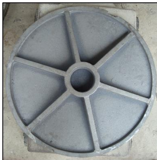
Figura 21. Diseño estructural de la parte inferior de la tapadera
