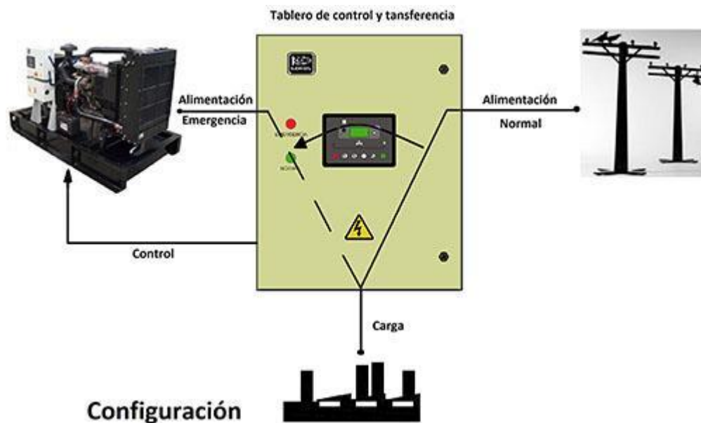
Figura 11. Tablero control y transferencia
