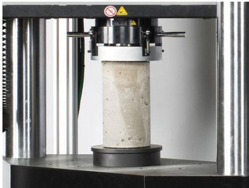
Fuente: BlogsPot. *Ensayo de compresión de cilindros de hormigón.*
