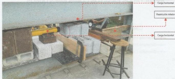
Ilustración 2: Sistema ensayo complementario
