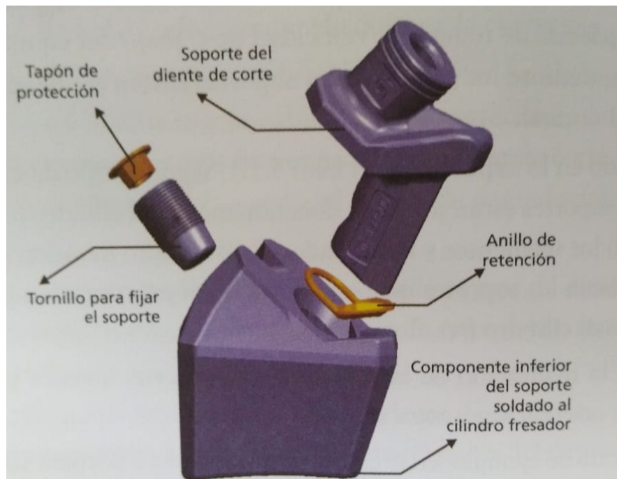
Figura 50. Esquema de fijación del portadiente
