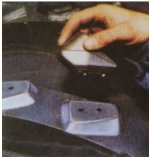
Figura 49. Fotografía del soporte de la punta de corte con guías
