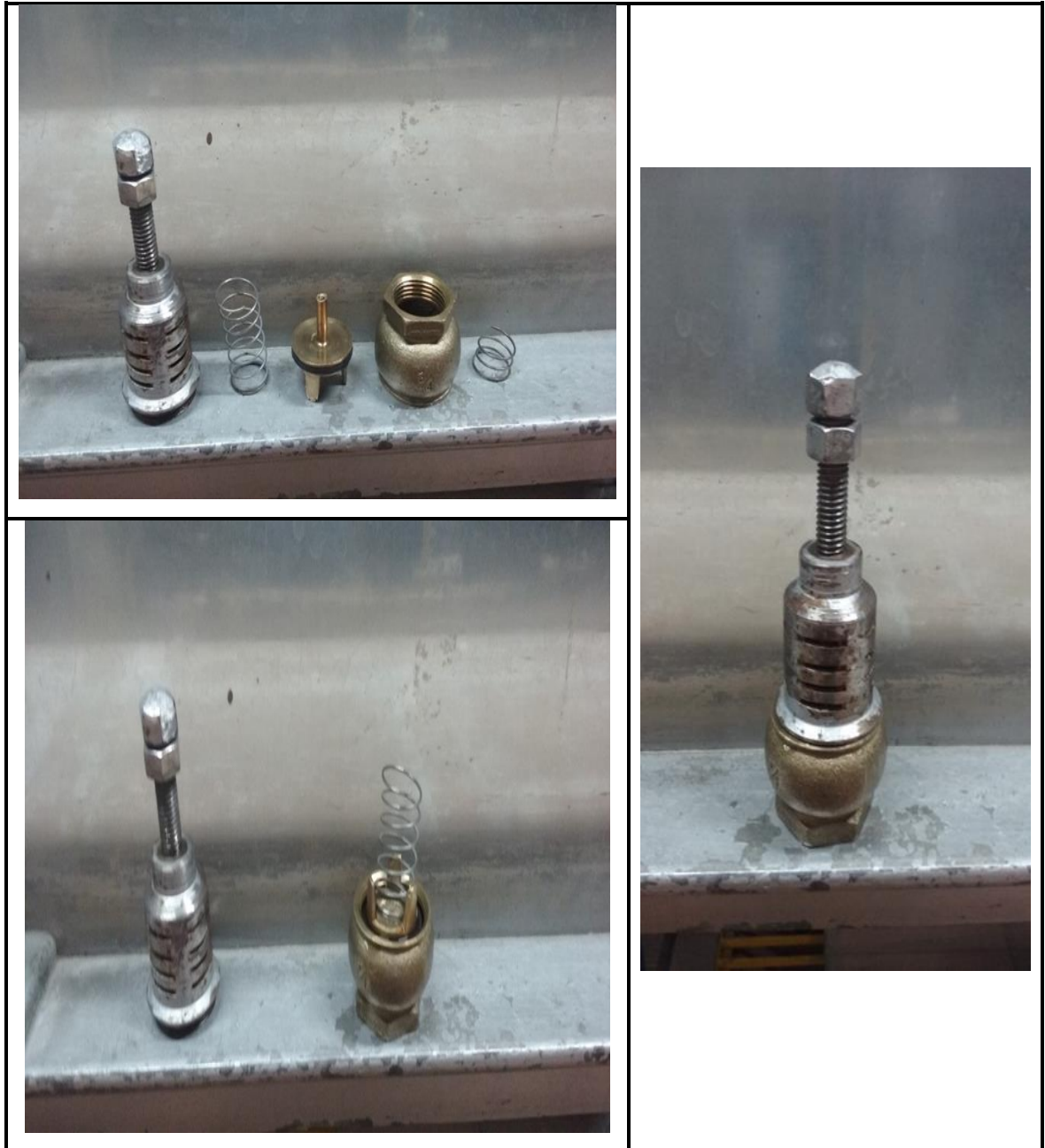
Figura 20. Armado de válvula bomba de ariete \frac{3}{4} "
