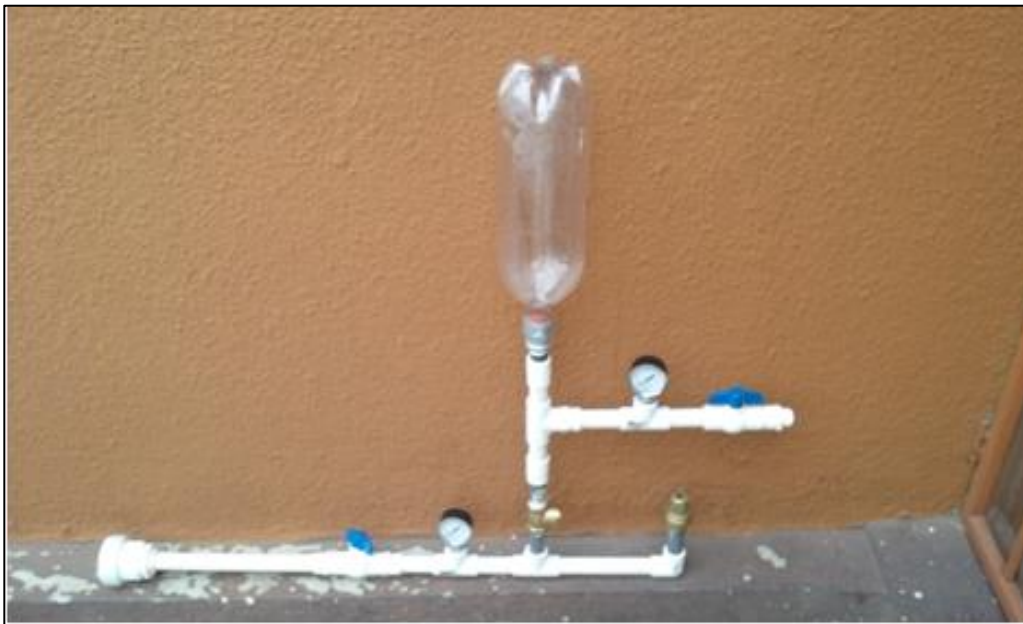
Figura 21. Modelo de bomba de ariete construido para el estudio
