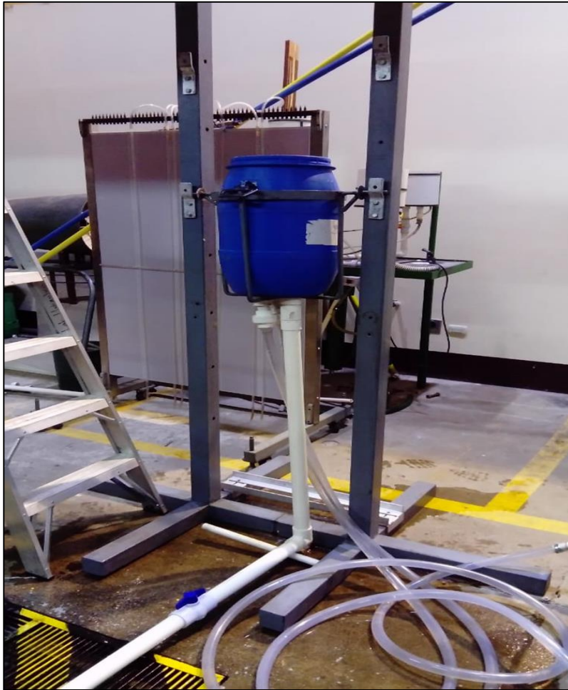
Figura 19. Estructuras sistema de bombeo (H = 1,50 m)
