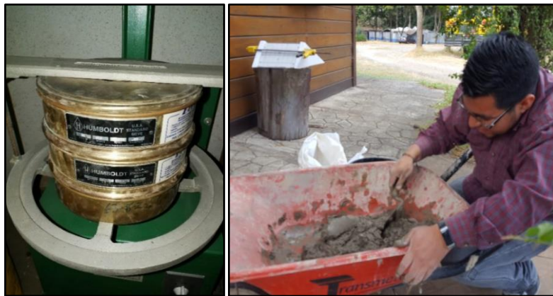
Figura 23. Tamizado y elaboración de mezcla para fundición de prisma rectangular
