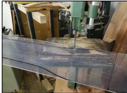
Figura 59. Corte de piezas de la reducción
