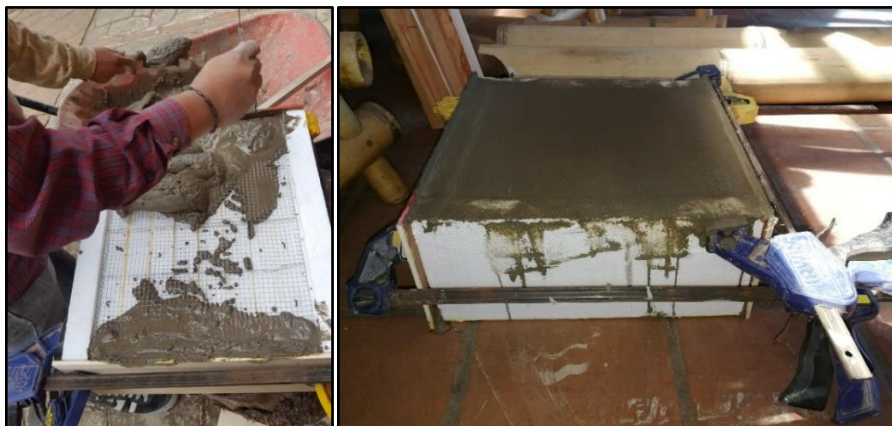
Figura 24. Fundición de prisma rectangular
