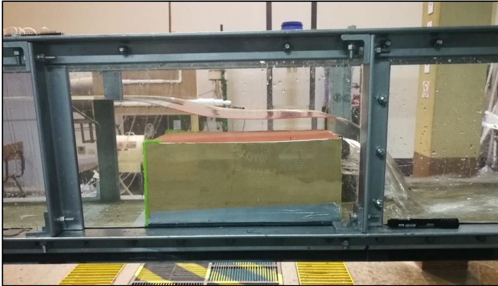
Figura 33. Perfil del flujo sobre el prisma rectangular
