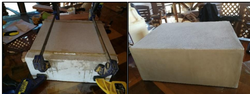
Figura 26. Pegado de foami a la base y caras laterales del prisma rectangular
