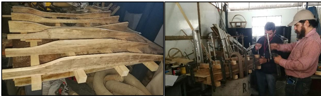
Figura 57. Elaboración de molde de la reducción
