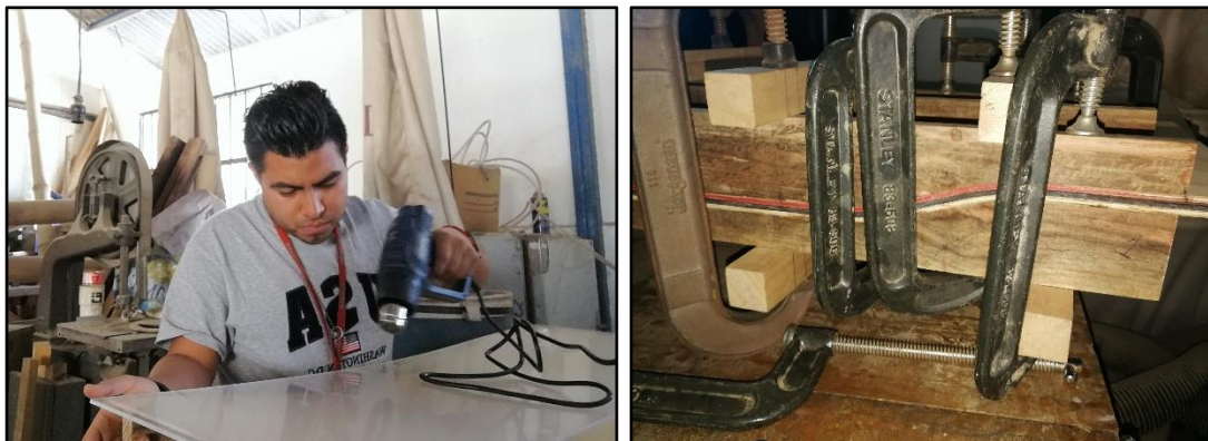
Figura 60. Moldeado de paredes de la reducción
