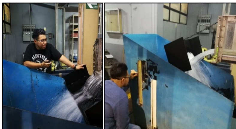
Figura 54. Aforo de caudal para el prisma triangular
