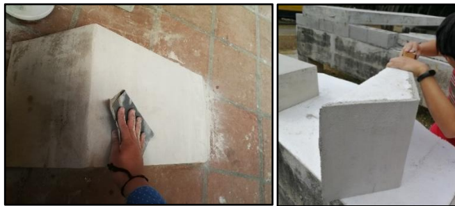
Figura 49. Lijado de la superficie del prisma triangular
