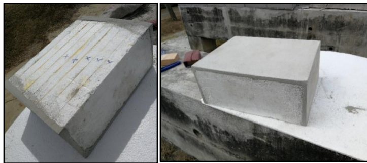
Figura 25. Lijado de la superficie del prisma rectangular
