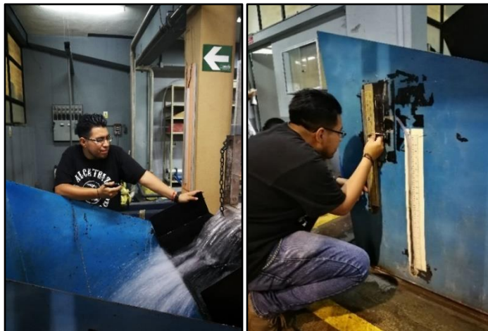
Figura 32. Aforo de caudal para el prisma rectangular
