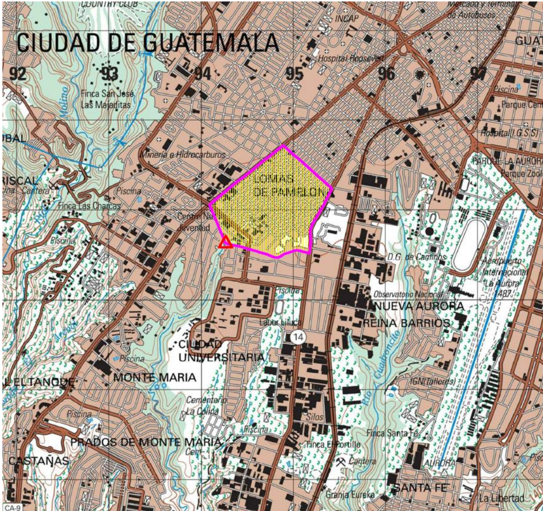
Figura 9. Área tributaria para el desfogue del colector en estudio, en la hoja cartográfica, escala 1:50,000
