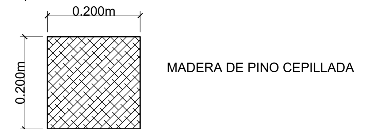
COLUMNA B-4 ESCALA 1:5
