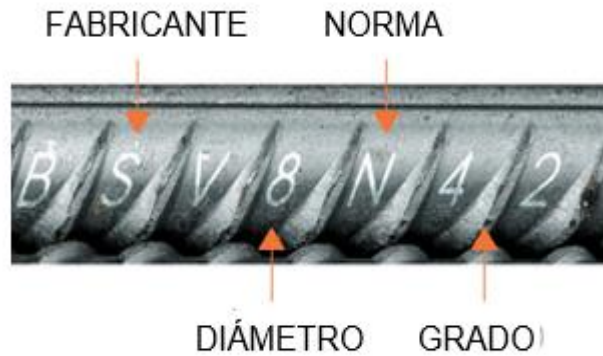
Figura 16. Partes de varilla corrugada
