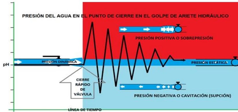
Figura 1. Presión en el punto donde se cierra la válvula
