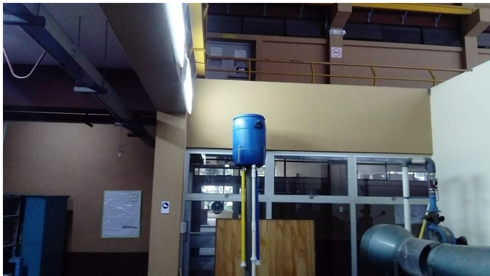
Figura 1. Equipo para ensayo de pérdida por fricción
