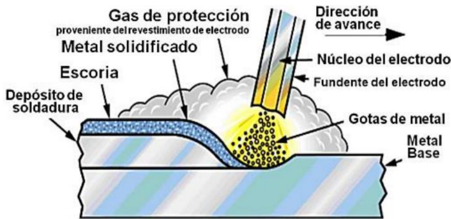
Figura 14. Elementos básicos de la soldadura SMAW
