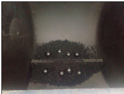
Figura 58. Ensayo de desgaste por máquina los Ángeles
