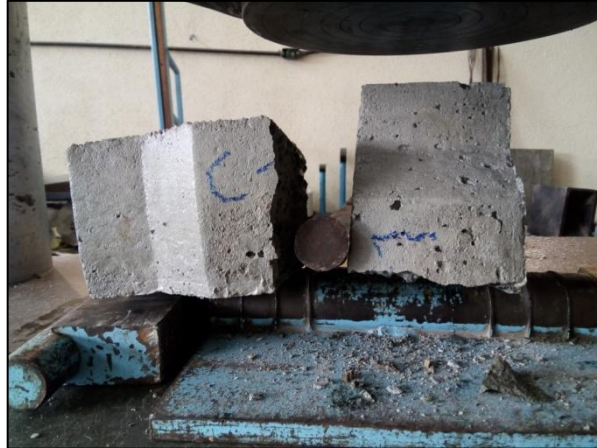
Figura 64. Adoquín ensayado a flexión
