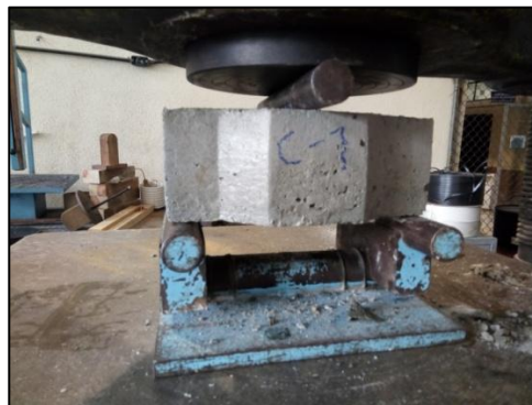
Figura 63. Adoquín ensayándose a flexión
