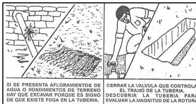
Figura 28. Inspeccionar la línea para detectar fugas y repararlas
