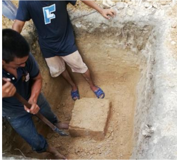
Figura 2. Excavación de toma de muestra y materiales utilizados
