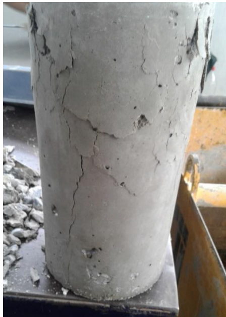
Falla de cilindro
