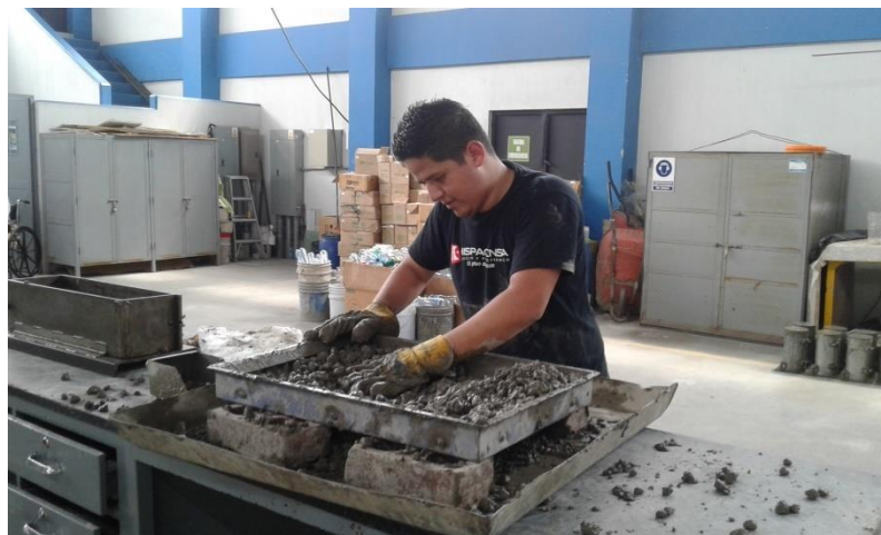
Tamizado de concreto fresco
