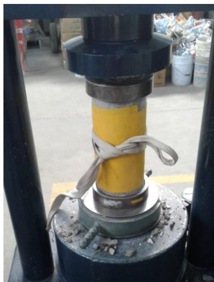
Colocación de cilindro en máquina para ser comprimido
