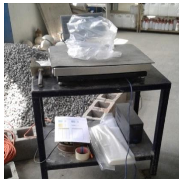
Determinación del peso de la bolsa que contendrá el material
