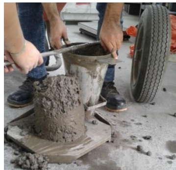
Medición de asentamiento
