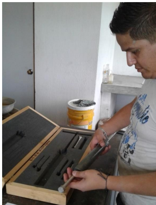
Ajuste de penetrómetro
