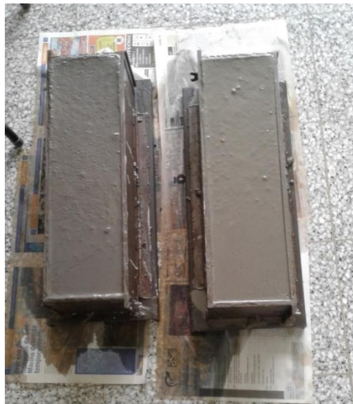
Vigas con el concreto tamizado
