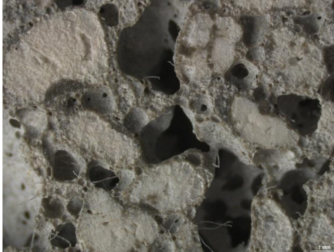
Figura 25. Ampliación 16X de la mezcla No. 6 (50 % de aire)
