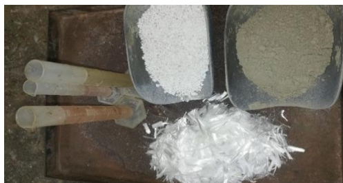
Figura 6. Componentes del concreto liviano de baja densidad (cemento, perlita expandida, aditivos y microfibras)
