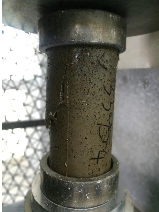
Figura 22. Ensayo estándar para resistencia a compresión
