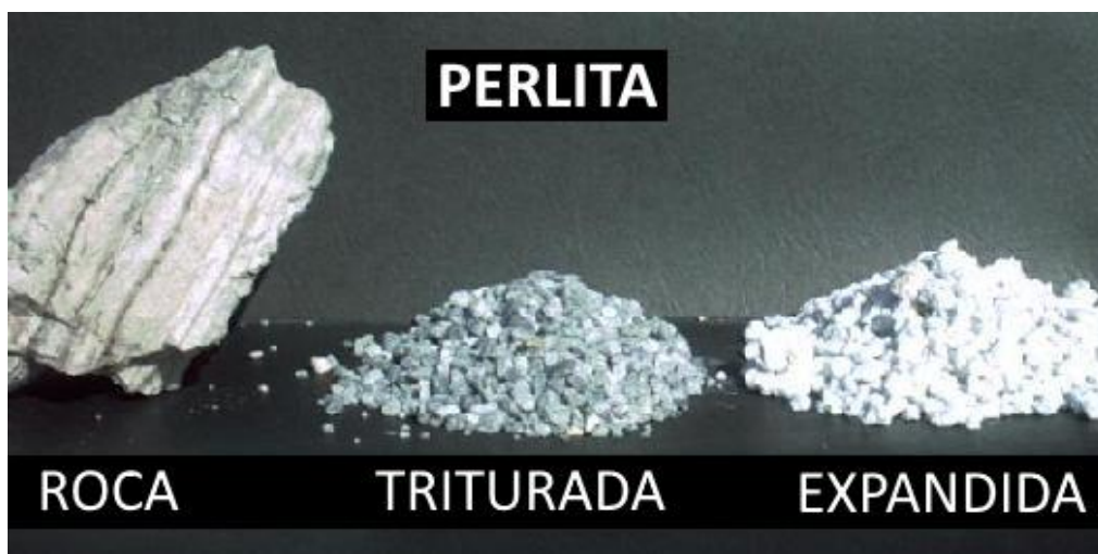
Figura 1. Morfología de la perlita en su forma de roca, triturada y expandida
