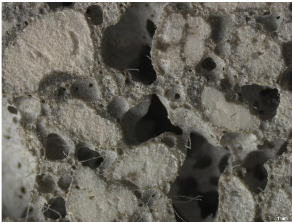
Figura 7. Ampliación 16X del concreto liviano de baja densidad, permite ver los vacíos incorporados al concreto
