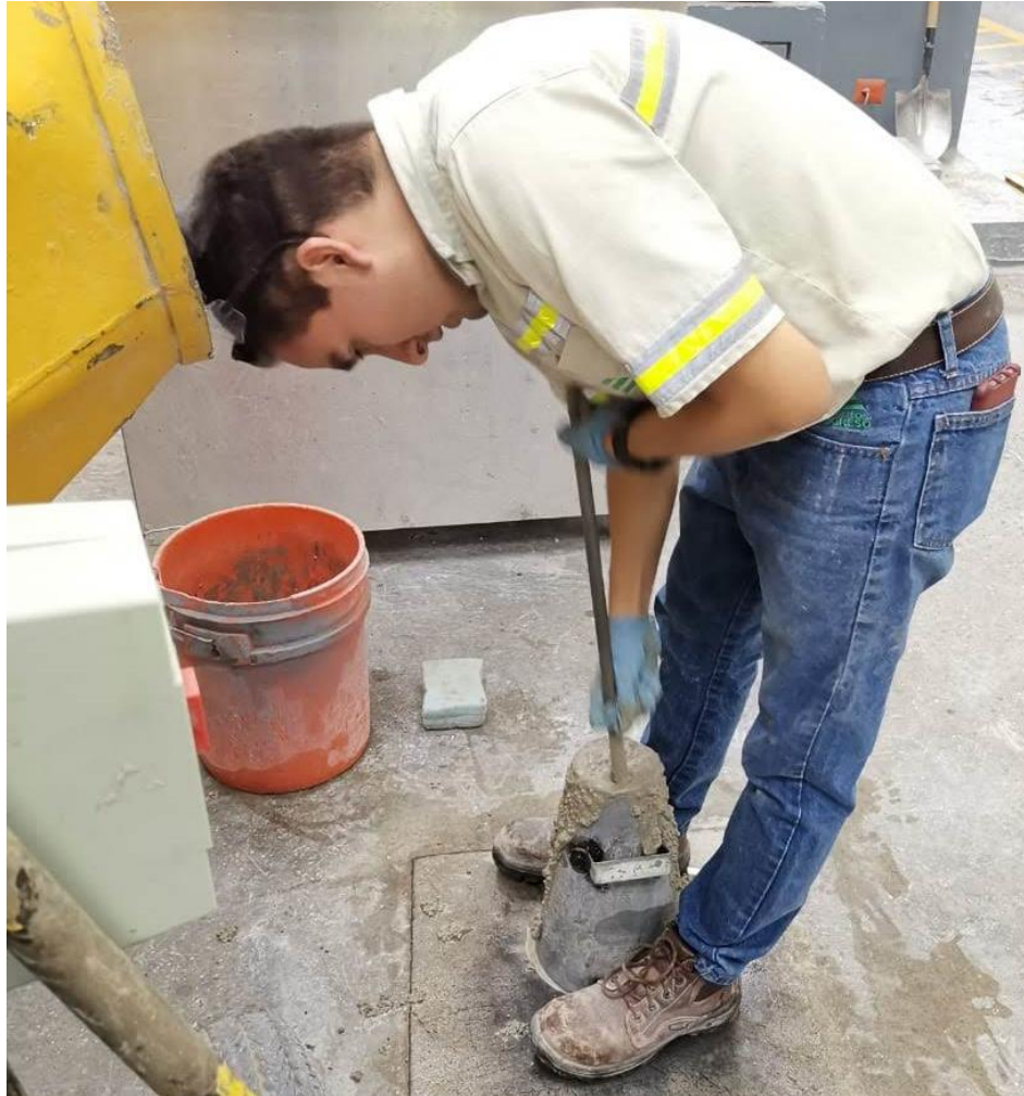
Figura 12. Determinación del asentamiento del concreto liviano de baja densidad
