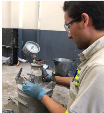
Figura 20. Ensayo para la determinación del contenido de aire del concreto hidráulico recién mezclado por el método de presión
