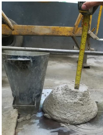
Figura 17. Ensayo para la determinación del asentamiento del concreto hidráulico
