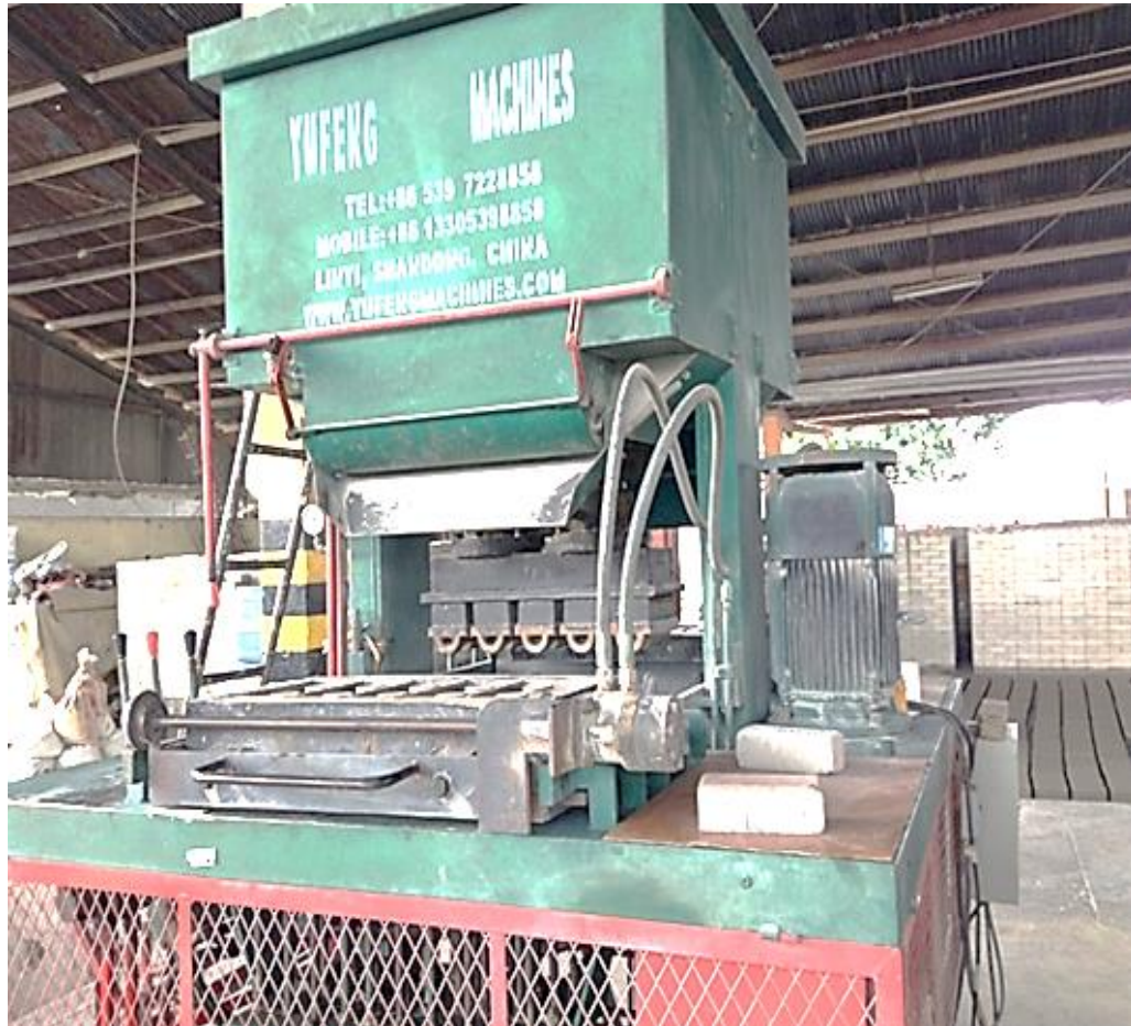
Figura 18. Depósito para material para la producción de bloques
