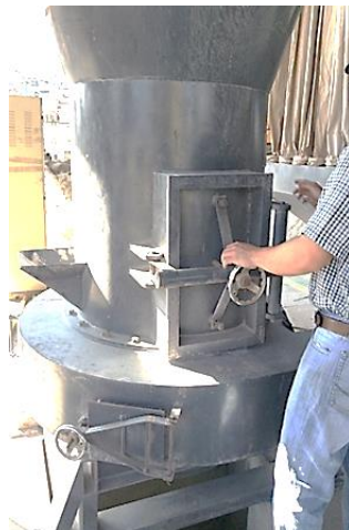
Figura 6. Puerta para mantenimiento
