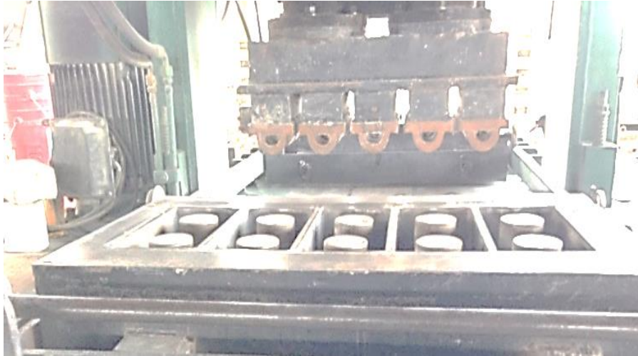
Figura 19. Moldes para fabricación de bloques
