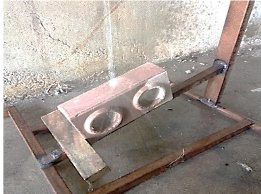
Figura 25. Aplicación de ensayo de erosión acelerada
