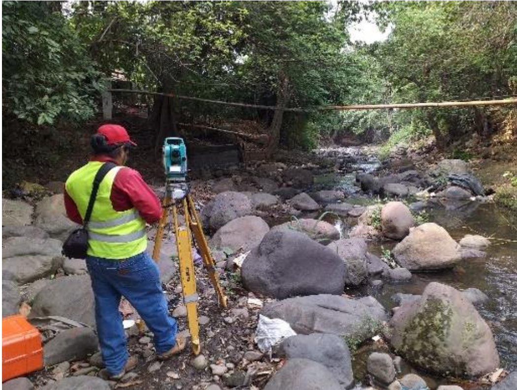
Figura 17. Levantamiento topográfico realizado en el río Muluá
