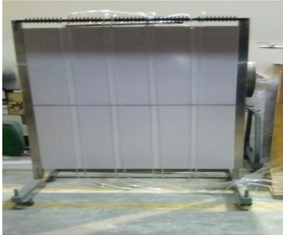
Figura 22. Tablero de piezómetros
