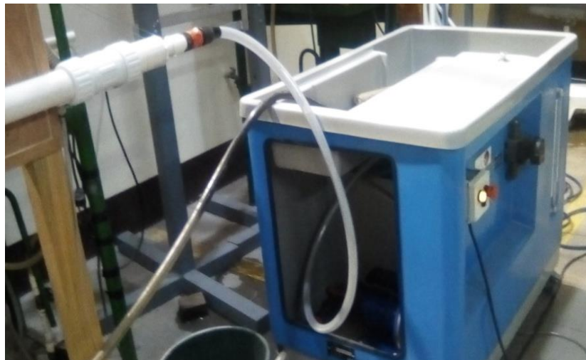
Figura 25. Banco hidráulico conectado al sistema de tuberías de PVC con contracciones súbitas
