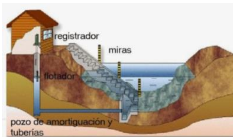
Figura 3. Esquema de una estación limnimétrica
