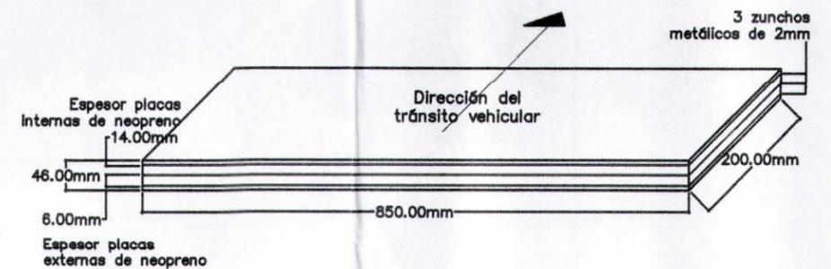
**DETALLE DE APOYO ELASTOMERICO**
