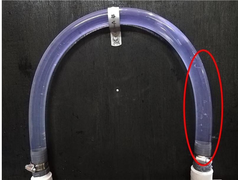
En la fotografía anterior, en el nivel del sifón, se observan las cavidades formadas durante los ensayos de laboratorio.
