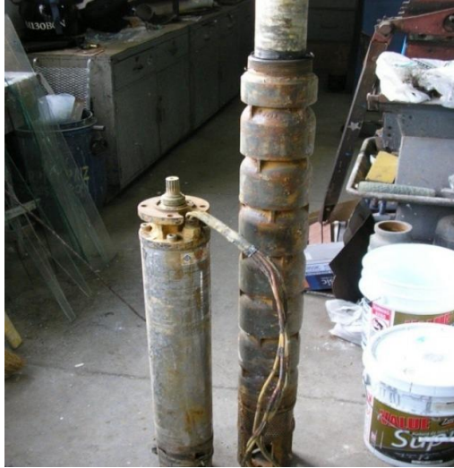
Figura 21. Bomba 2 antes de su instalación en pozo 2
