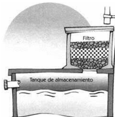
Figura 24. Depósito de almacenamiento
