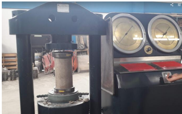
Figura 12. Máquina para ensayos de compresión de cilindro
