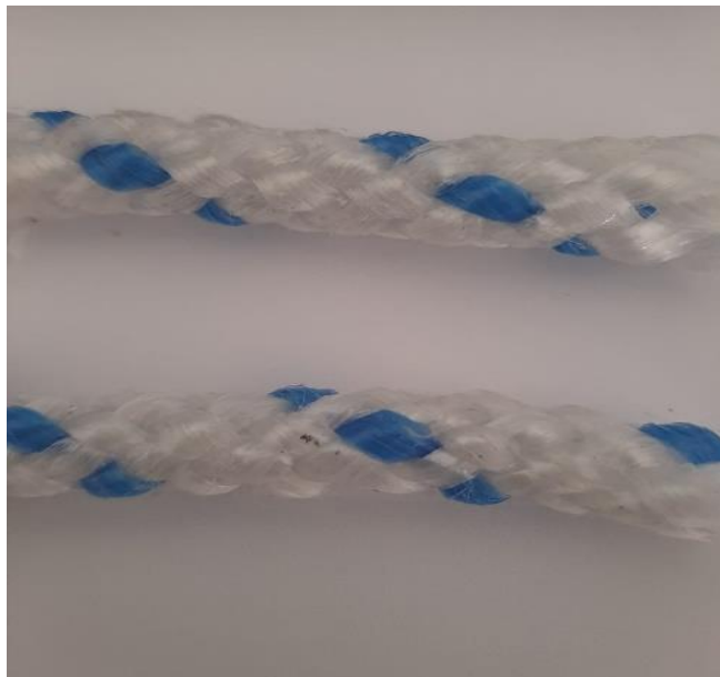
Figura 48. Trenza con el cambio de piñones de máquinas A1 y N1
