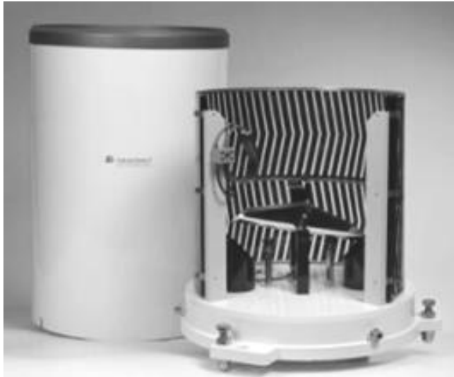
Figura 9. Pluviómetro de cangilómetro
