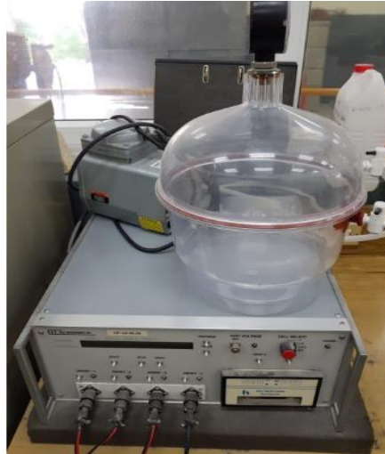
Figura 20. Máquina de indicación eléctrica de la capacidad del concreto para resistir la penetración de iones de cloruro
