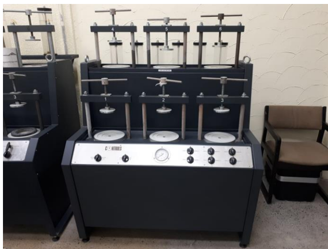
Figura 19. Máquina de ensayo de profundidad de penetración de agua bajo presión al concreto endurecido
