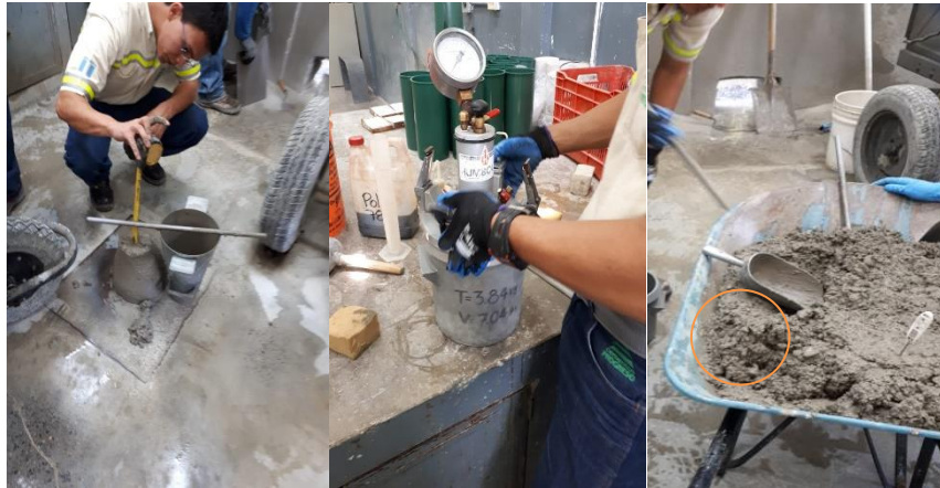
Figura 17. Ensayos realizados al concreto fresco
