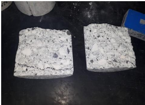
Figura 22. Muestreo de marca de profundidad de agua en probetas penetradas bajo presión
