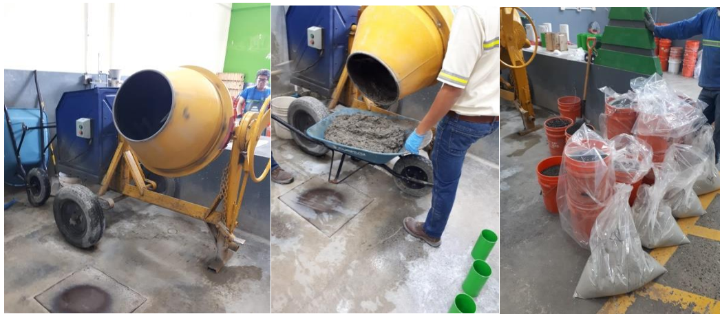
Figura 16. Pesaje y mezclado de componentes del concreto
