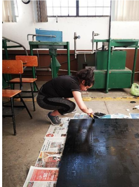
Figura 37. Impermeabilización del tablero nuevo
