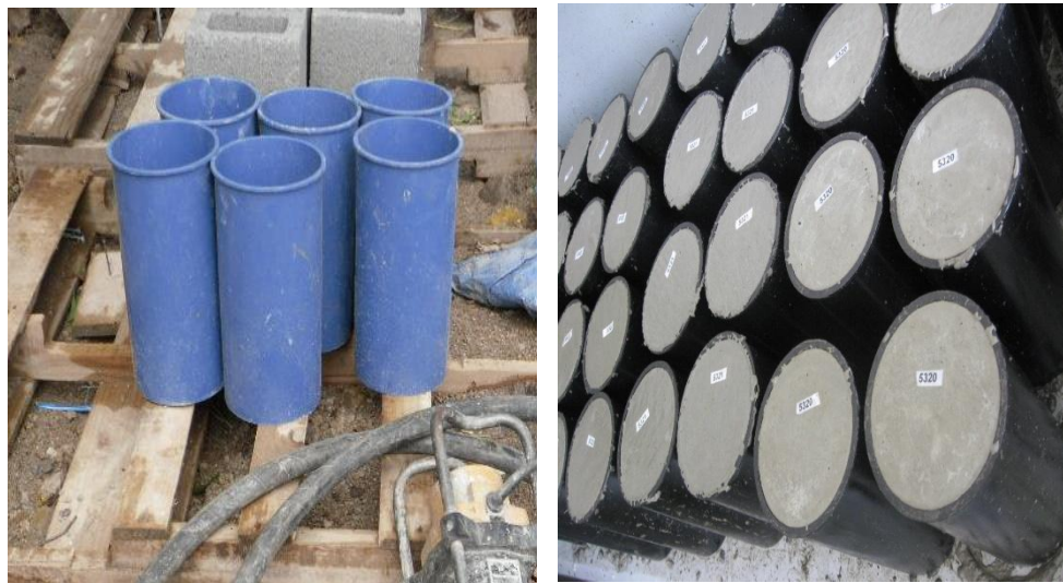
Figura 15. Especímenes para prueba de resistencia a la compresión
