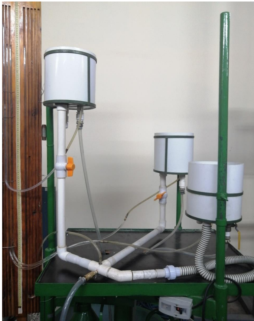
Figura 22. Circuito de tuberías ramificadas
