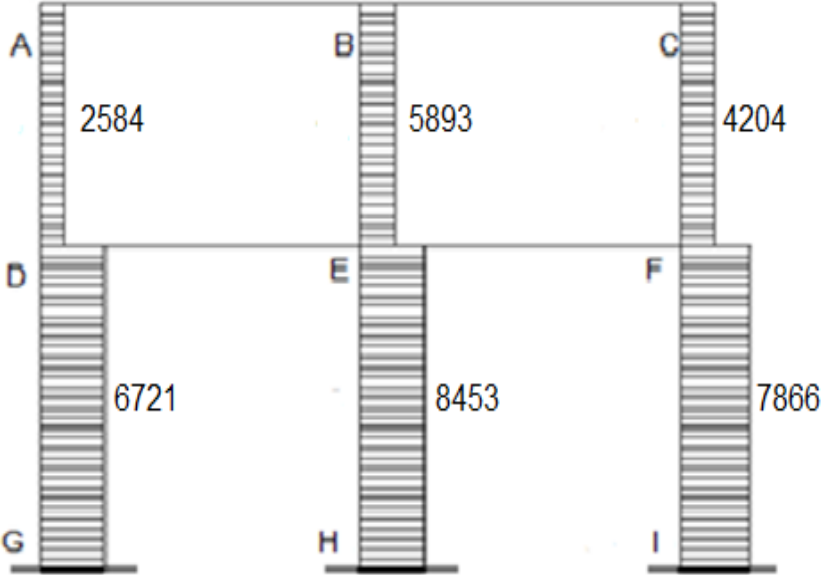
Figura 56. Diagrama de cortante último en columnas, sentido “Y”, módulo 1
