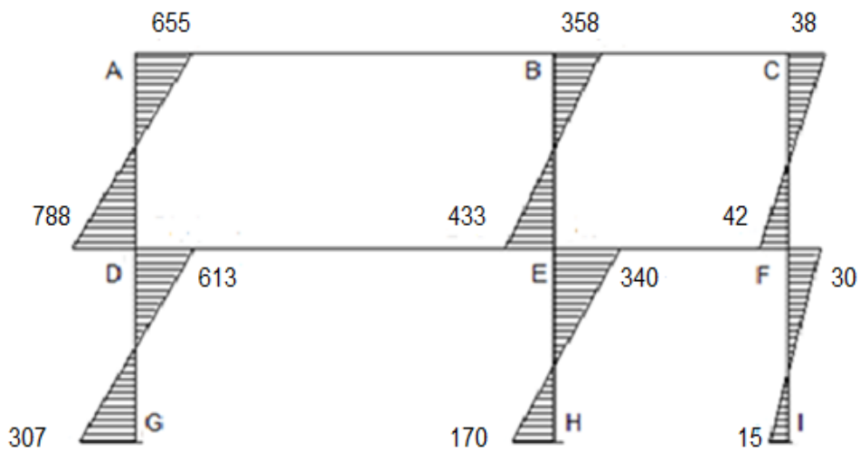
Figura 44. Diagrama de momento en columnas MARCO “C”, debido a la carga viva, sentido Y módulo 1
