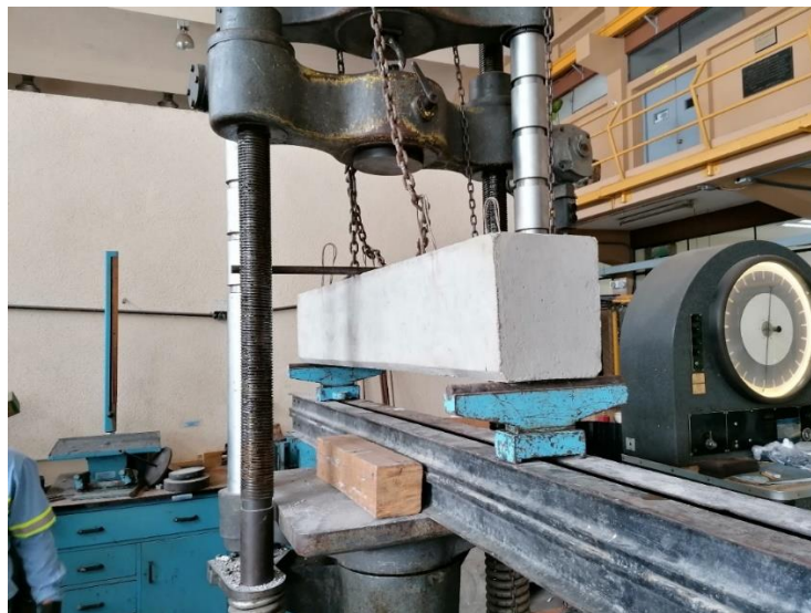
Figura 25. Colocación de formaviga para ensayo
