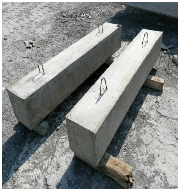
Figura 24. Vigas tradicionales fundidas
