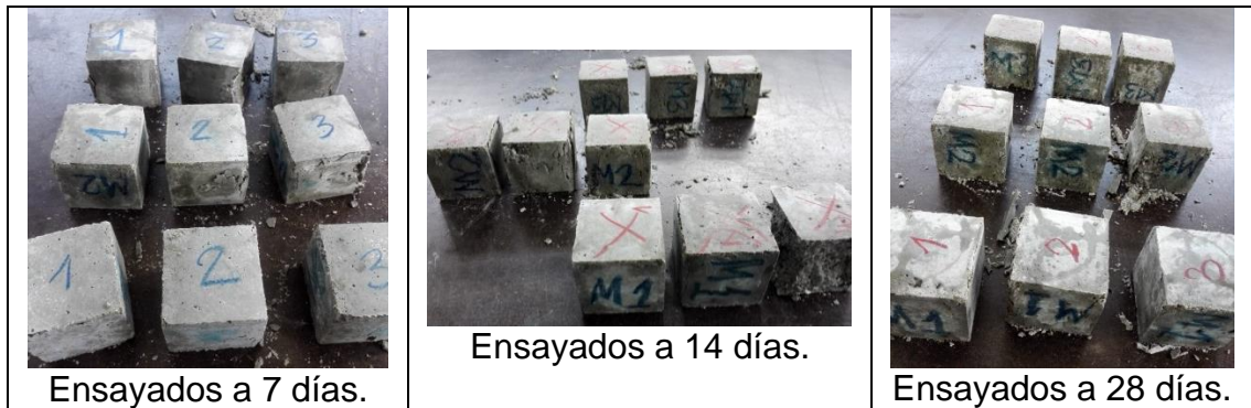
Figura 9. Cubos ensayados a las edades establecidas
