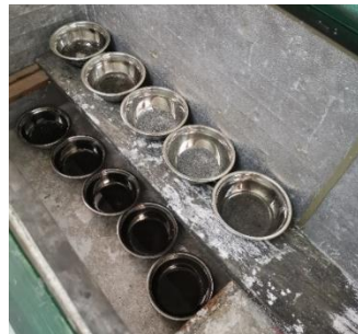
Figura 14. Ensayo de abrasión por sulfatos
