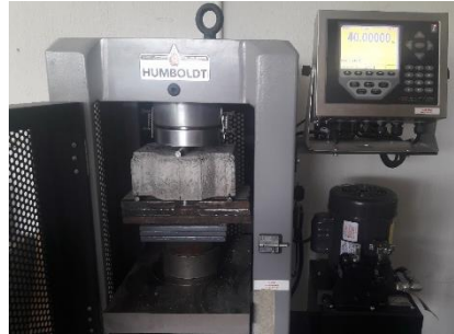
Figura 28. Colocación del adoquín en la máquina universal
