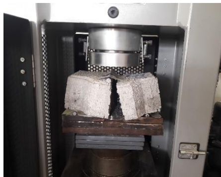
Figura 29. Aceptación de la ruptura de los adoquines
