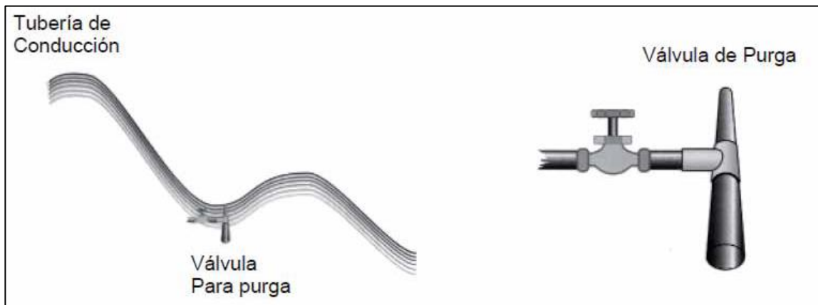
Figura 33. Válvulas de limpieza o de purga
