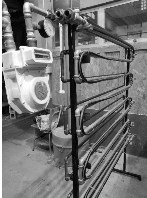
Figura 24. Módulo experimental utilizado en el ensayo, cobre, hierro galvanizado y Pe-Al-Pe
