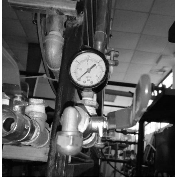
Figura 25. Manómetros utilizados en medición de presión
