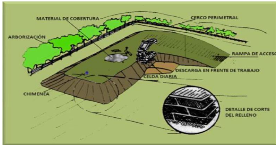
Figura 11. Relleno sanitario manual
