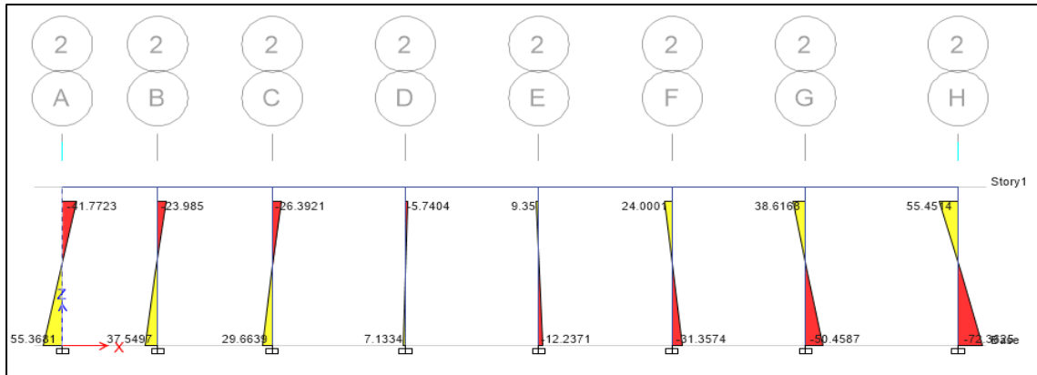
Figura 38. Diagrama de momentos en columnas, debido a carga sísmica, eje X
