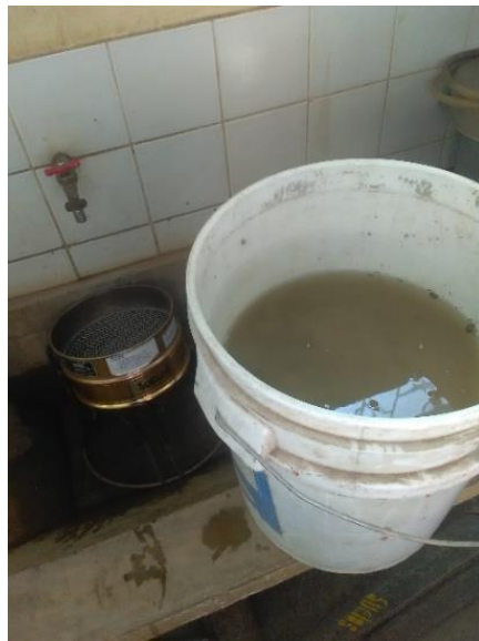
Figura 33. Gravas en proceso de saturación
