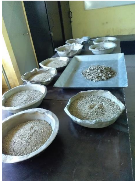
Figura 32. Muestras de suelo en estado natural con gravas separadas
