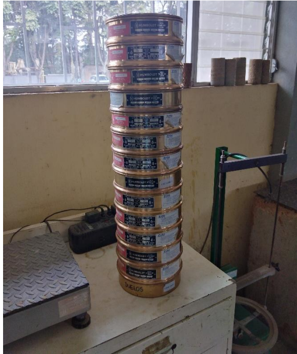
Figura 26. Equipo utilizado para el ensayo de granulometría
