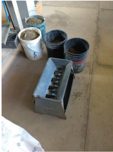
Figura 29. Cuarteador de muestras
