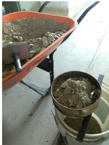
Figura 30. Tamizado de la muestra de suelo
