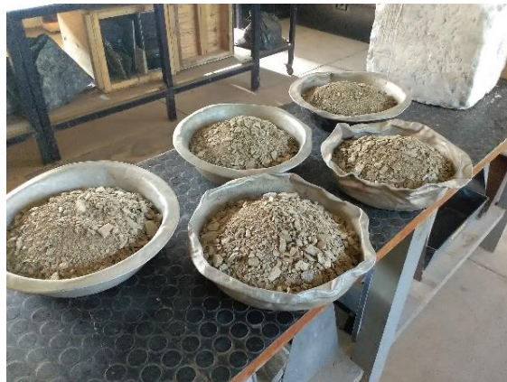
Figura 31. Muestras de suelo en estado natural sin gravas separadas
