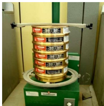
Figura 10. Equipo utilizado para ensayo granulométrico
