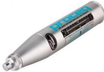
Nota. Equipo utilizado la medición de resistencia de una superficie. 2001 screening Eagle Technologies, PROCEQ. Derechos reservados
