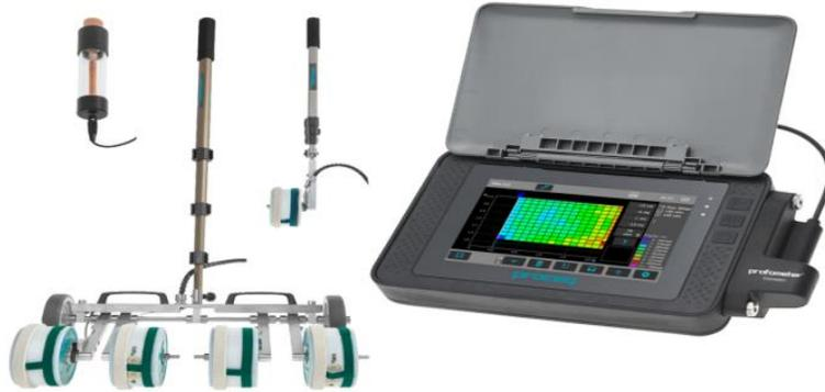
Nota. Equipo utilizado en la estimación de la corrosión para el ensayo de potencial de corrosión de media celda. 2020 screening Eagle Technologies, PROCEQ. Derechos reservados
