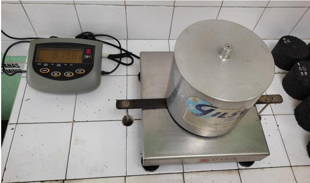
*Nota.* La imagen muestra el proceso de pesado del equipo de laboratorio conjunto al material de la mezcla, el cual se realizó en el Laboratorio Proequipos S.A. Elaboración propia.
