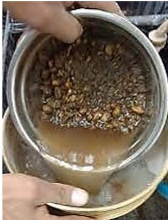
*Nota.* La imagen muestra el proceso de lavado del material, el cual se realizó en el Laboratorio Proequipos S.A. Elaboración propia.
