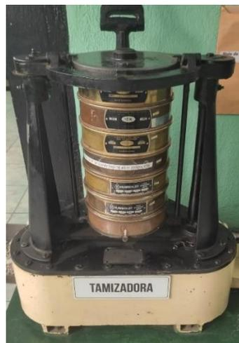
*Nota.* La imagen muestra el material siendo tamizado, y se realizó en el Laboratorio Proequipos S.A. Elaboración propia.
