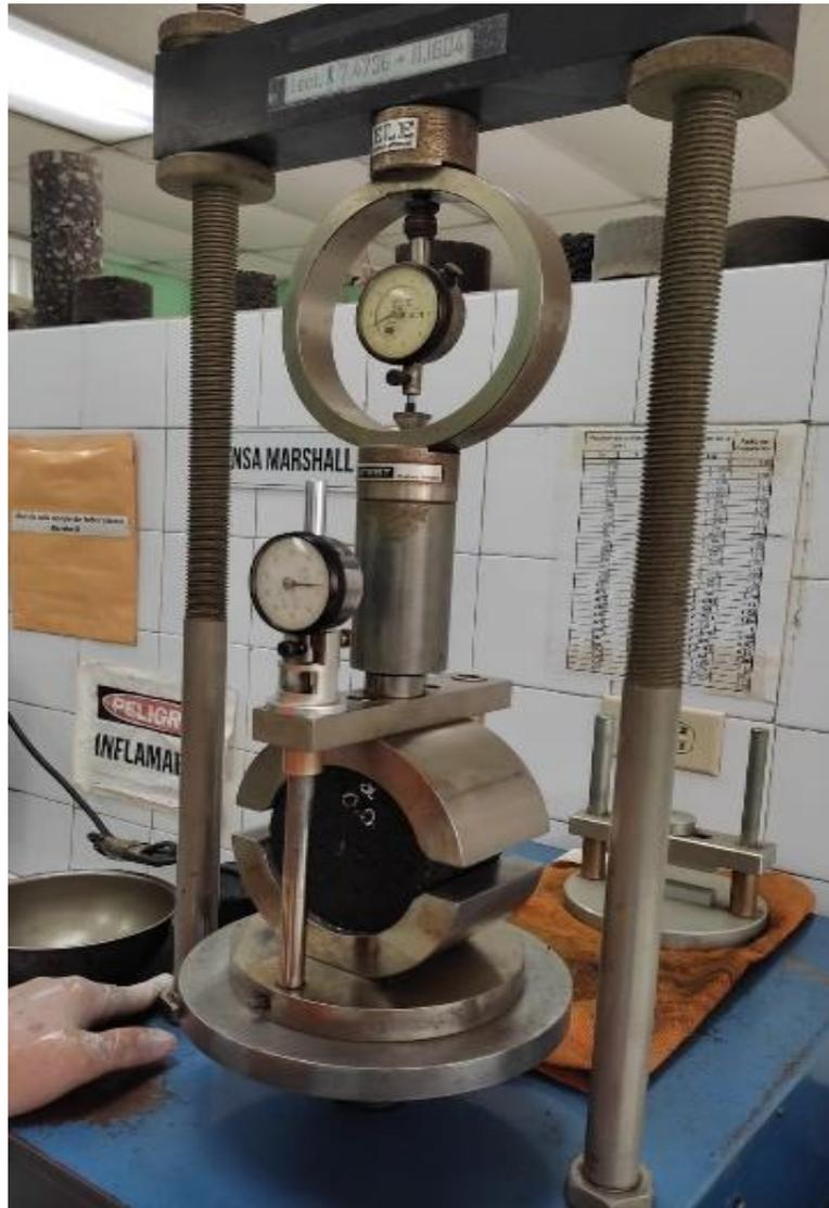
*Nota.* La imagen muestra el ensayo de Marshall sobre las briquetas realizadas para investigación, realizado en el Laboratorio Proequipos S.A. Elaboración propia.
