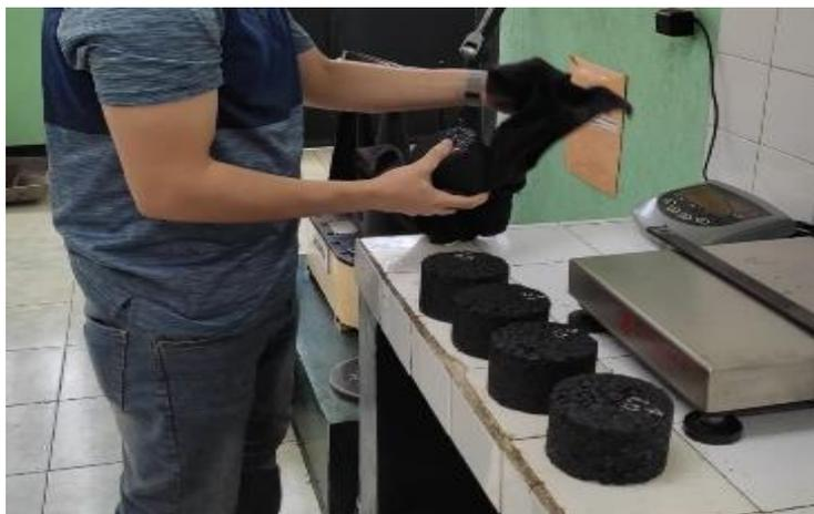
*Nota.* La imagen muestra el secado de las briquetas usando el equipo de laboratorio, y se realizó en el Laboratorio Proequipos S.A. Elaboración propia.
