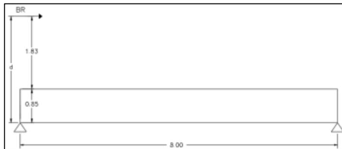
*Nota.* Dibujo de carga de fuerza de frenado actuante en viga. Elaboración propia, realizado con AutoCAD 2019.
