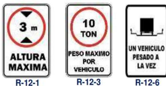
*Nota.* Ejemplos de algunas señales que restringen la altura, el peso o el tipo de carga de los vehículos. Obtenido de la SIECA (2014). *Manual Centroamericano de Dispositivos Uniformes para el Control del Tránsito* [Imagen]. (<https://www.sieca.int>), consultado el 10 de marzo de 2023. De dominio público.
