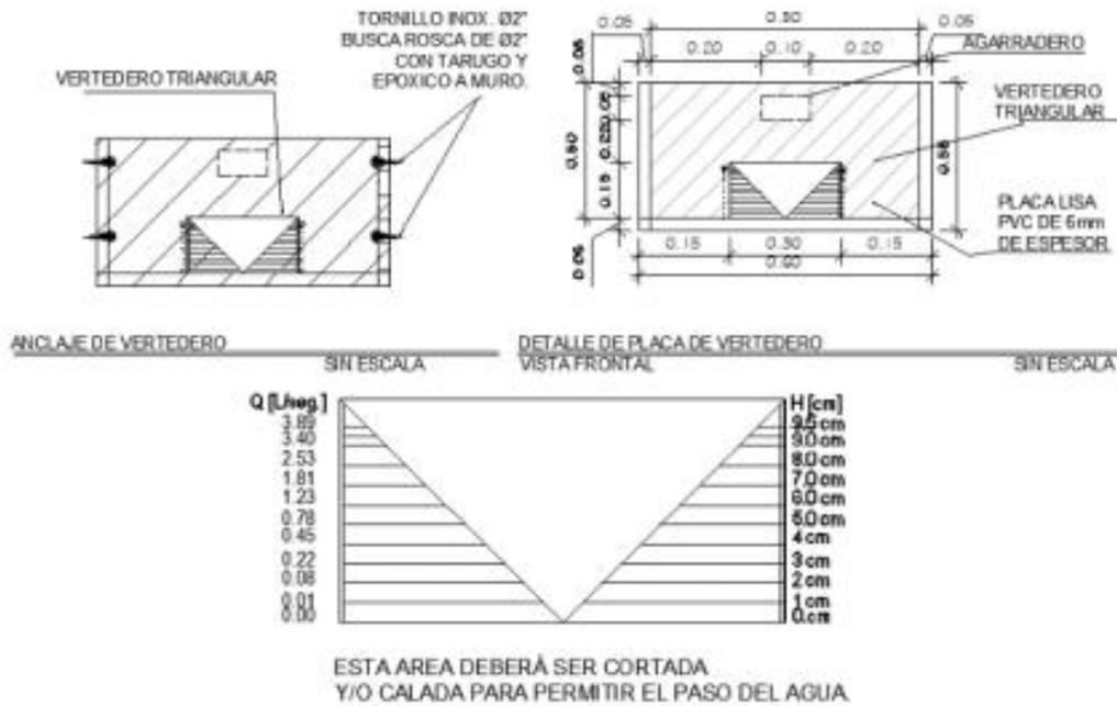
*Nota.* Diseño de la sección para toma de muestras de una PTAR. Obtenido de WATER SYSTEM MANAGEMENT, S.A. (2022). *Planta de tratamiento de aguas residuales – tramo SB2 VAS.* (p.10). WASYMA, S.A.
